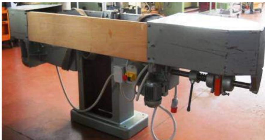
**Descrizione:** LEVIGATRICE NATRIBOM - orizzontale - con piano d'appoggio da mm. 1200x450 - regolabile in altezza - altezza nastro mm. 200
