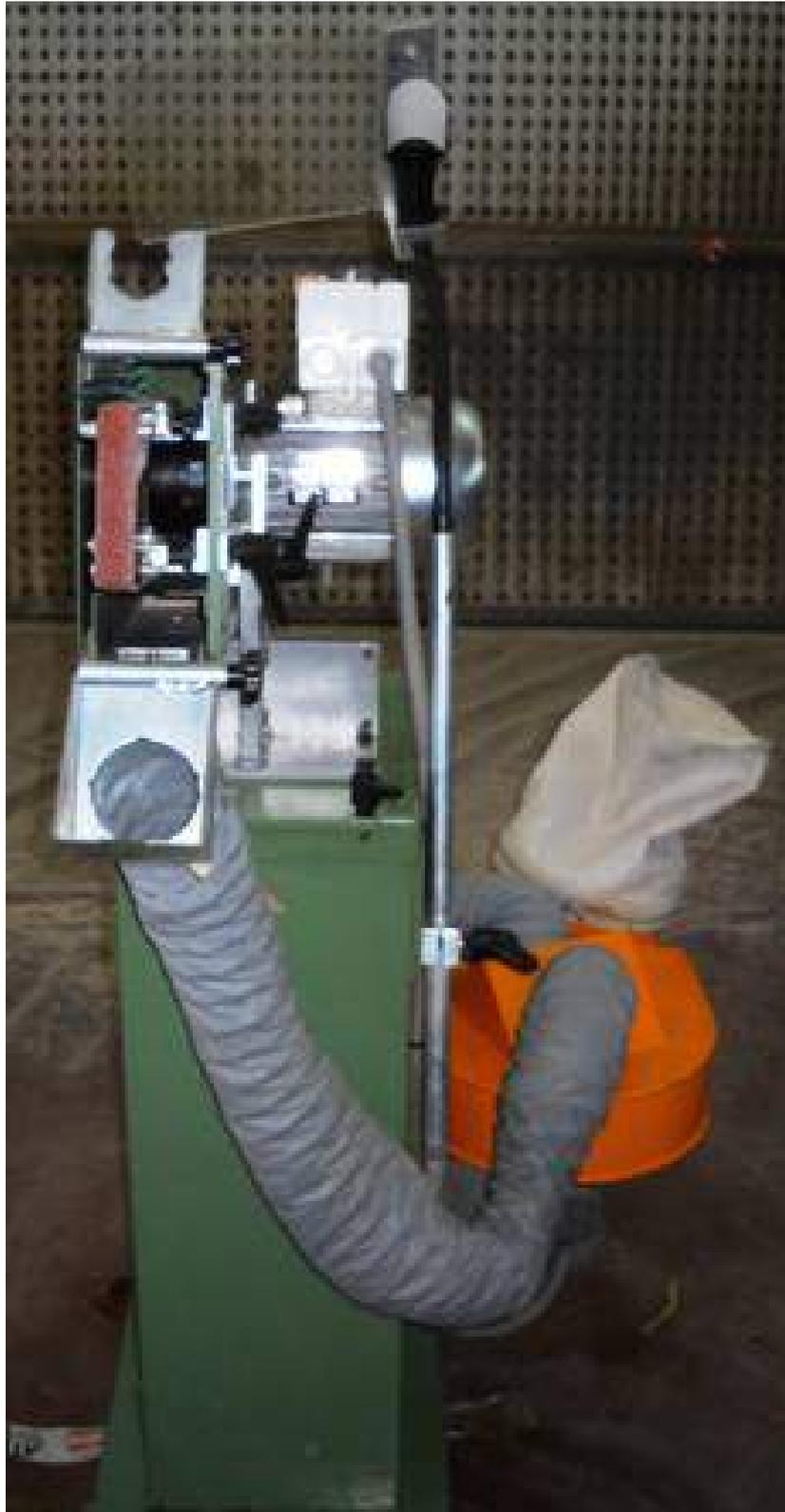
**Descrizione:** LEVIGATRICE FINTEC ORIZZONTALE - con nastro mm. 30 - con aspirazione e luce
