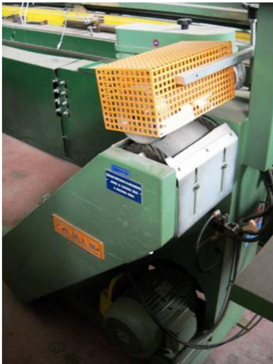
**Descrizione:** LEVIGATRICE C.A.M.A.M. MOD.LOL/75/RU - MATRICOLA N.21 - GRUPPO D'AVANZAMENTO PER PEZZI TONDI,QUADRI, PIATTI - MOTORE LEVIGATRICE HP 7,5 - MOTORE AVANZAMENTO HP 0,35 - A TRE VELOCITA' - DIMENSIONI NASTRO ABRASIVO MM.200X3000 - MISURE D'INGOMBRO MM750X1500 H1400 - PESO KG 420
