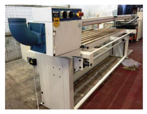
**Descrizione**: LEVIGATRICE A NASTRO SAMCO MOD. LL3000 - sollevamento motorizzato - motore 2 vel. 1450-2800 g/min. hp3 vel. 2800 g/min. hp4 - gruppo aspirante
