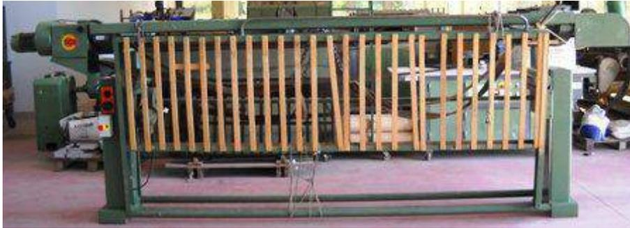
**Descrizione:** LEVIGATRICE A NASTRO MABO MOD. SPECIAL - da mt.3 - a doppio collo d'oca - sollevamento motorizzato - motore a due velocità 1450-2800
