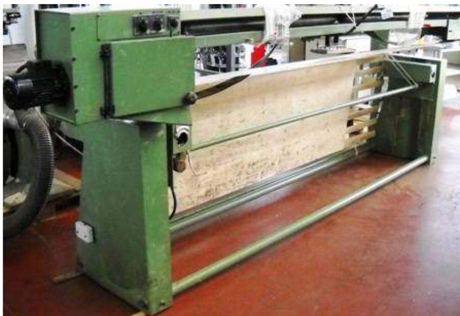
**Descrizione:** LEVIGATRICE A NASTRO DA MT. 3 - doppio collo d'oca - sollevamento motorizzato del piano - motore a due velocità 1400-2800 - motore hp4+3
