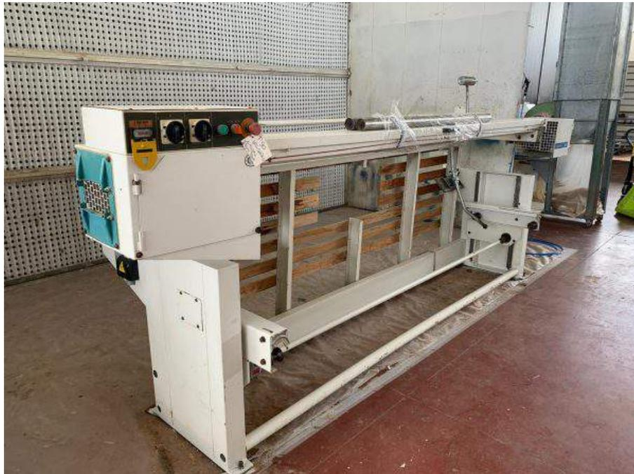
**Descrizione:** LEVIGATRICE A NASTRO MINIMAX MOD. L/S 3000 - a normativa CE - motore hp4 kw 3 ad una velocità - lunghezza piano di lavoro mm. 3000 - larghezza del piano di lavoro mm. 1100 - corsa verticale del piano mm. 580 - larghezza del nastro abrasivo mm. 150 - sviluppo del nastro abrasivo mm. 8100 - velocità di scorrimento del nastri mt./sec. 140 - profondità del collo montanti mm. 820 - diam. pulegge mm. 250 - motore sollevamento hp 0,5
