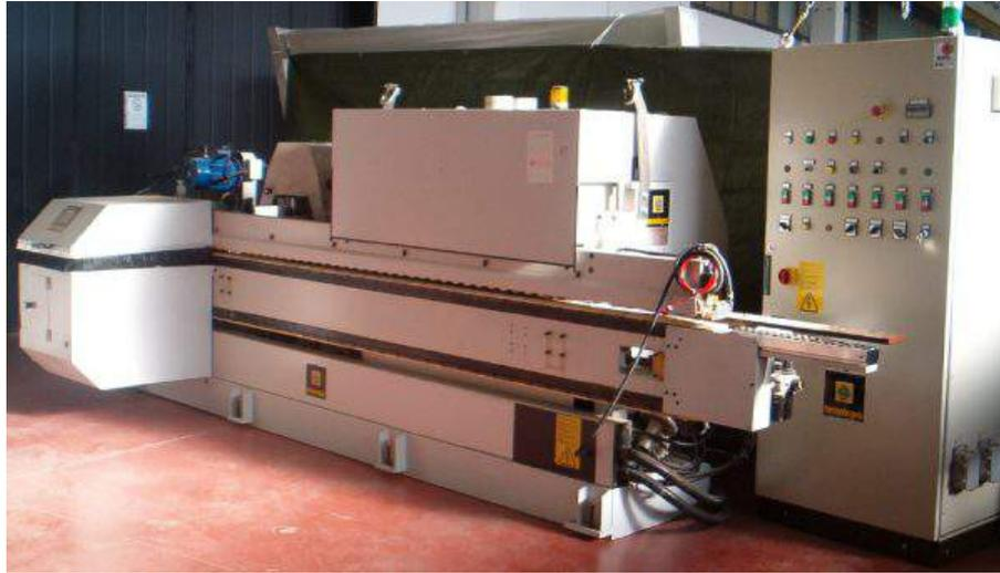
**Descrizione:** LEVIGABORDI TECNOLEGNO MOD.COMPACT 40 - MOTORE KW 16 - a norme CE
