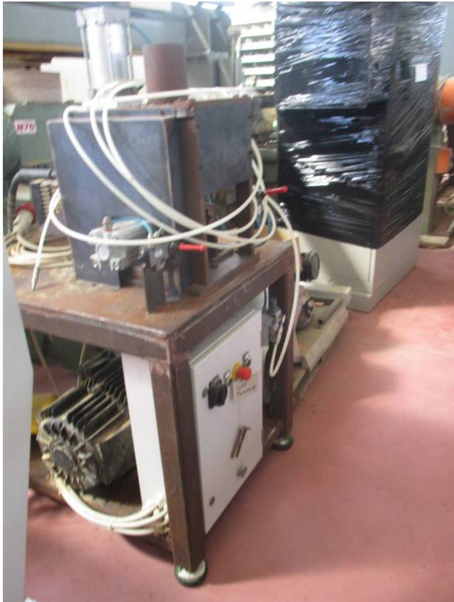
**Descrizione:** INTESTATRICE + FRESATRICE PER GAMBE DA TAVOLI - INSTESTATRICE A DUE LAME - FRESATRICE PER LA TRACCIA
