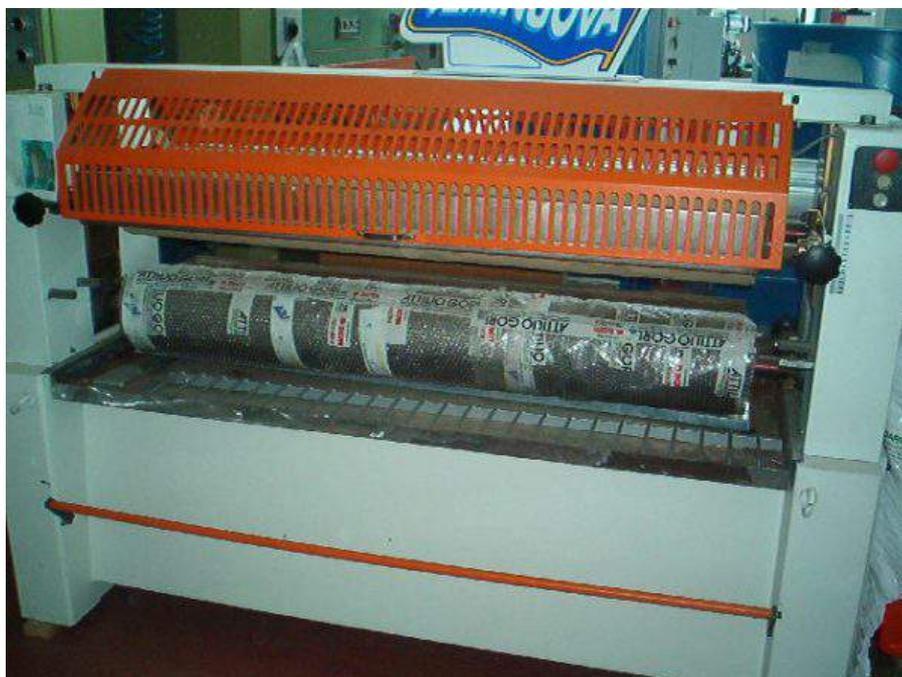
**Descrizione:** INCOLLATRICE FIN TIPO SC288 1300 - a 2 rulli diam.200 da mm. 1300 (rigati a mm.1,5 per dosare la colla a 120 gr. a mt. quadro) - revisionata a nuovo
