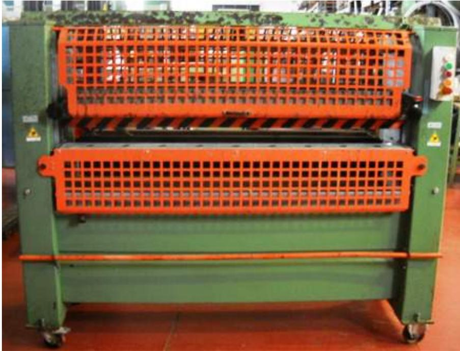
**Descrizione:** INCOLLATRICE FIN MOD. SC2 R 1300 - a normative CE - potenza kw 0,37 - a due rulli da mm. 1300
