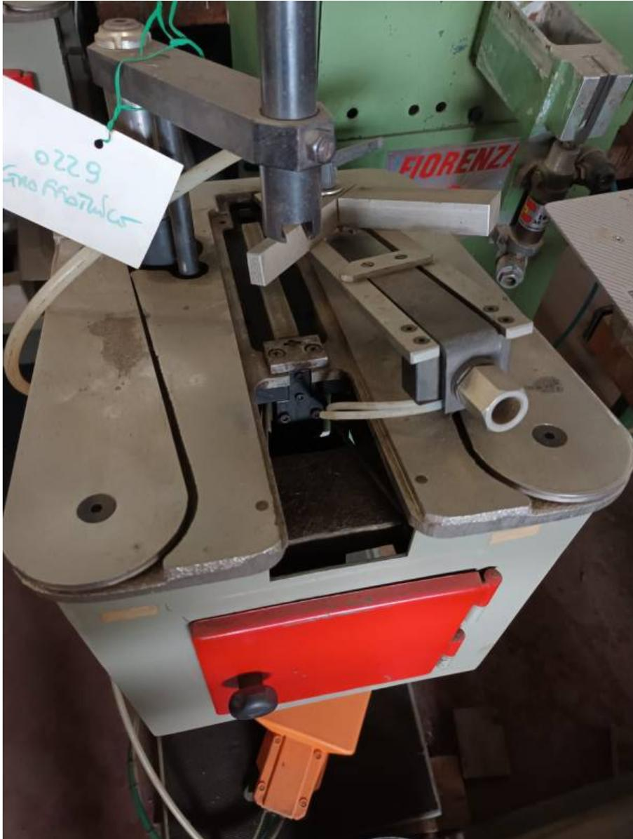
**Descrizione:** GRAFFATRICE OMGA JOINT 501 P - graffatrice pneumatica verticale per l'assemblaggio di quadri in legno di ogni essenza - squadra di appoggio scorrevole per poter inserire due graffe alla distanza desiderata predisponendola con l'ausilio di due fermi - pressore frontale che assicura un migliore bloccaggio dei due pezzi durante l'operazione di aggraffatura.
