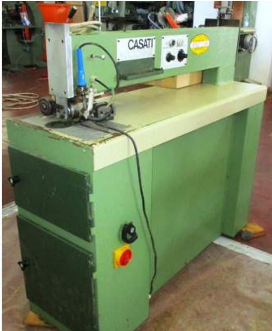
**Descrizione:** GIUNTATRICE A FILO CASATI MOD. Z1000 - sbraccio mm.1000 - spessore materiale mm.0,4-2 - velocità di avanzamento variabile m/min.10-25
