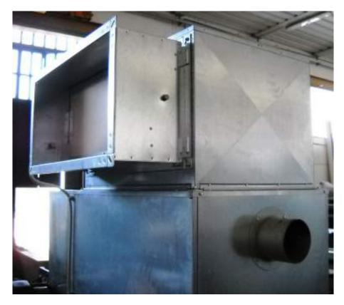
**Descrizione**: GENERATORE CON CENTRALINA A METANO BPS CLIMA MOD. B23 - a norme CE - con serranda tagliafuoco - bocchetta superiore in uscita - SENZA BRUCIATORE
