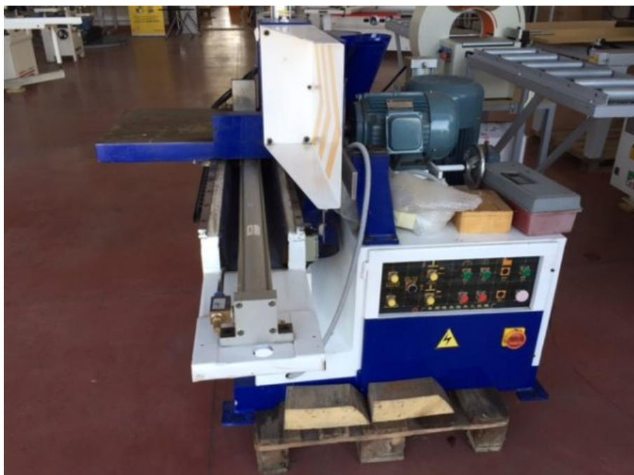
**Descrizione:** FRESATRICE FINGER JOINTING MOD. FJL MXB 3515 C Completa di : - disco intermedio LO - pettine regolabile standard FJL - flangia speciale per pacco frese
