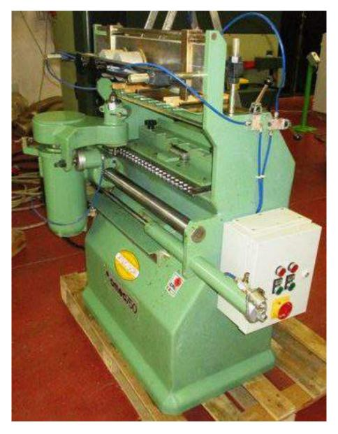
**Descrizione**: FRESATRICE AUTOMATICA PER INCASTRI A CODA DI RONDINE OMEC MOD. 750 - per cassetti e parti di mobili - larghezza utile di lavoro mm. 480 - spessore dei frontali dei cassetti mm.60 - dimensione fissa del piano mm. 25 - potenza del motore elettrico del mandrino porta punta hp 1,5 2 poli - potenza del motore elettrico traslazione punta hp 1,5 4 poli
