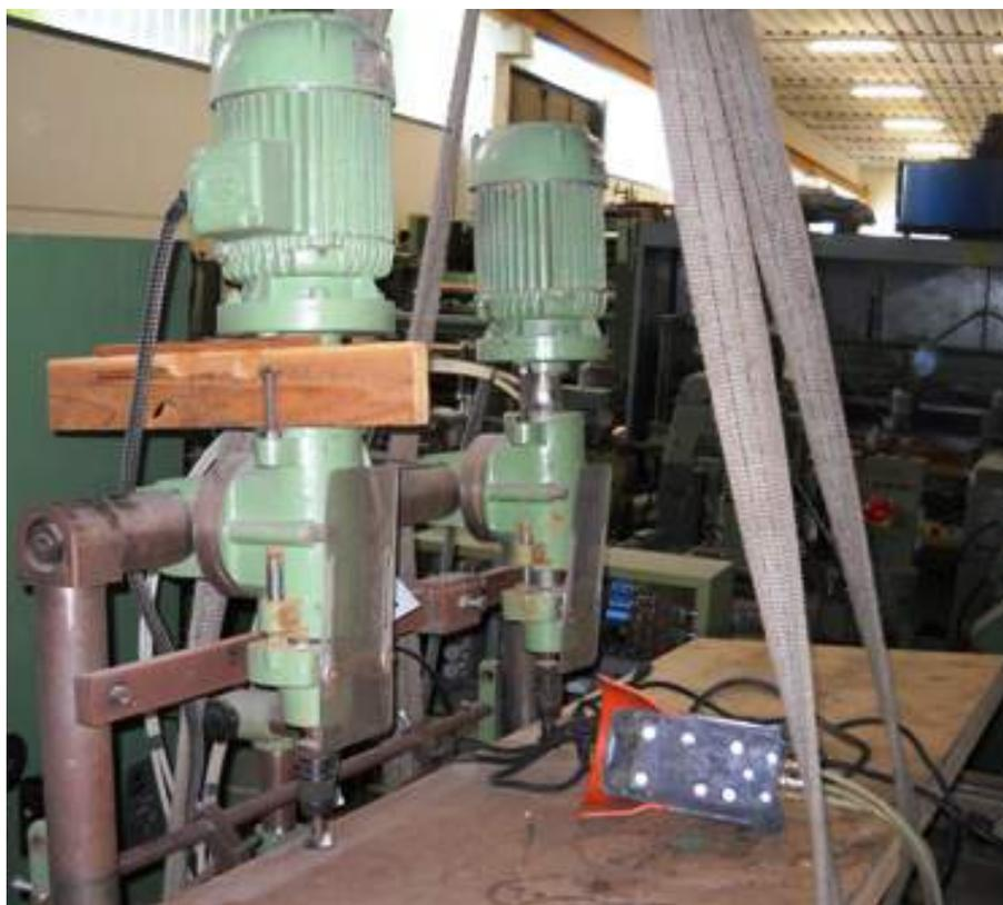
**Descrizione:** FORATRICE VERTICALE SORBINA 50 - a due teste con motore di hp 1,5 cad.
