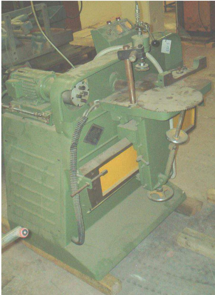
**Descrizione:** FORATRICE / INTSTATRICE A 5 PUNTE PADE MOTORE LAMA HP 3 MOTORE PUNTE HP 3 CON CARRO PRESSORE PNEUMATICO
