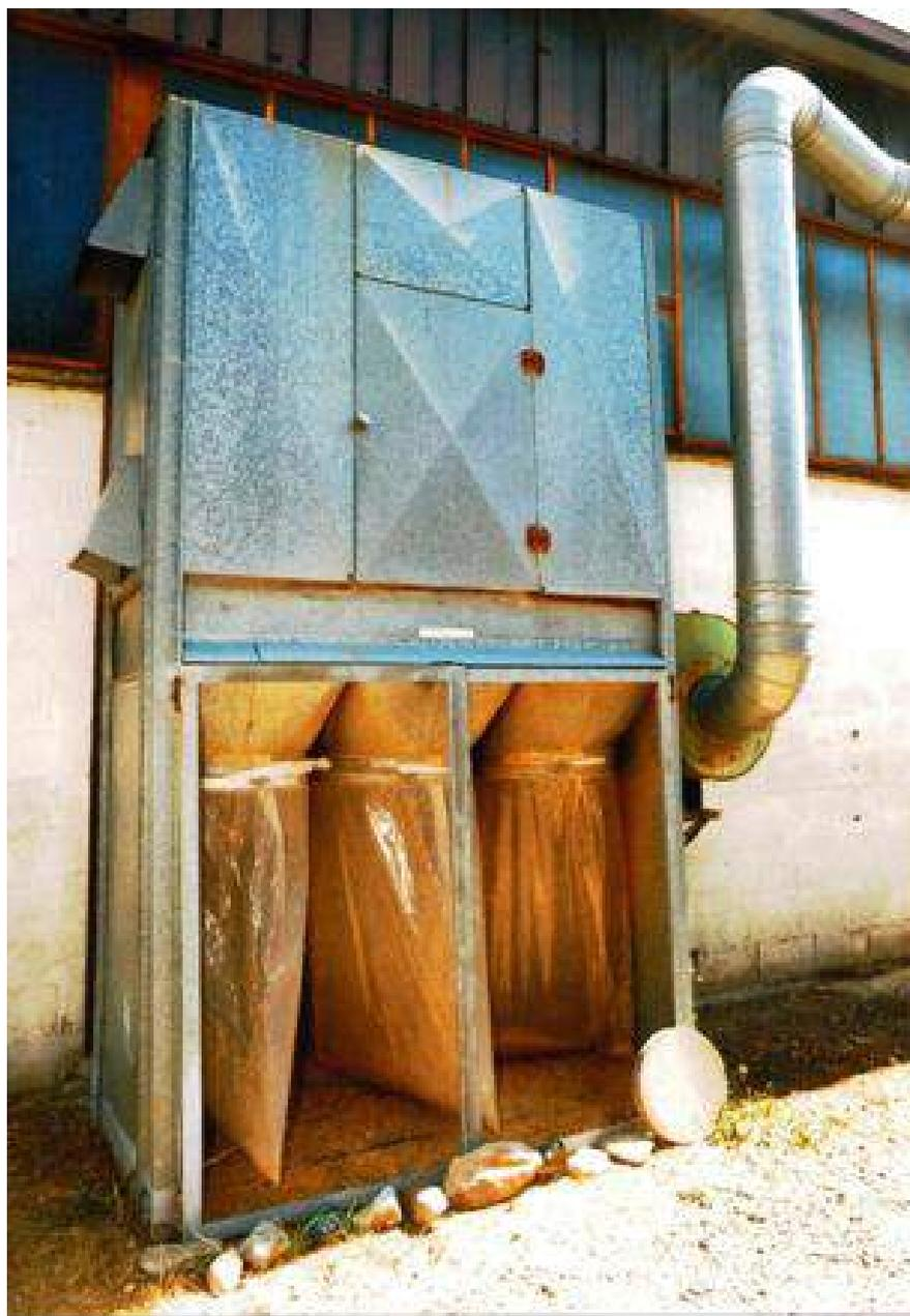
**Descrizione:** FILTRO - n.3 sacchi di raccolta diam. 600 - con elettroventilatore - n.18 maniche diam.250 lunghezza mm.1500 - motore kw 5,5/hp 7,5
