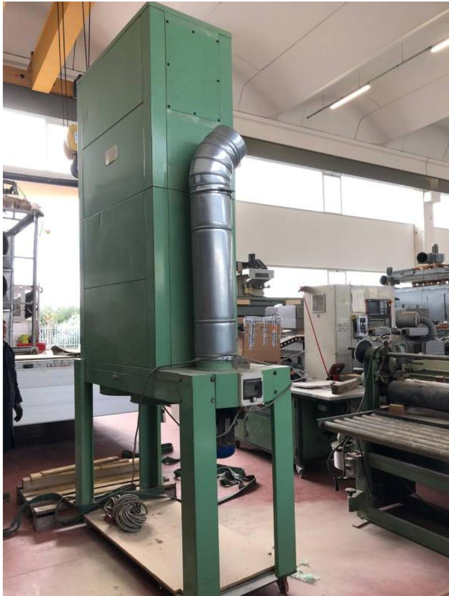
**Descrizione:** FILTRO A DUE SACCHI DIAM. 500 - n.12 maniche filtranti diam. 200 altezza mm. 1950 - con scuotitore - carenato - elettroventilatore da kw 4
