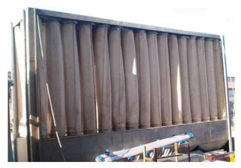
**Descrizione**: FILTRO A 4 SACCHI DI RACCOLTA DIAM.500 - n.48 maniche filtranti diam200x1500 - motore hp 7,5 - senza carenatura - senza scuotitore
