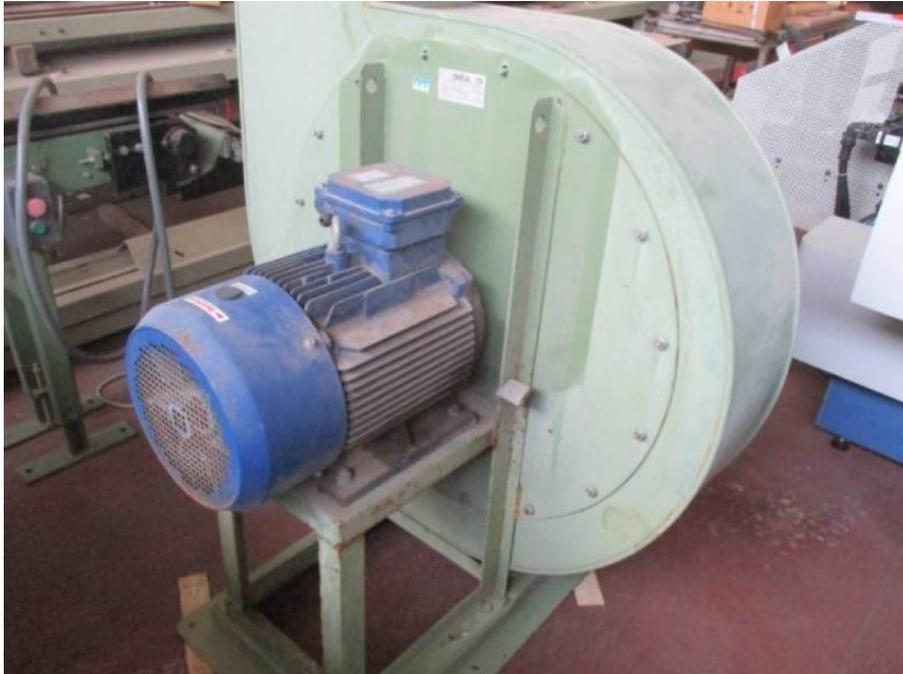
**Descrizione:** ELETTOVENTILATORE STIAVELLI KW 15 - rotazione oraria, vista lato motore
