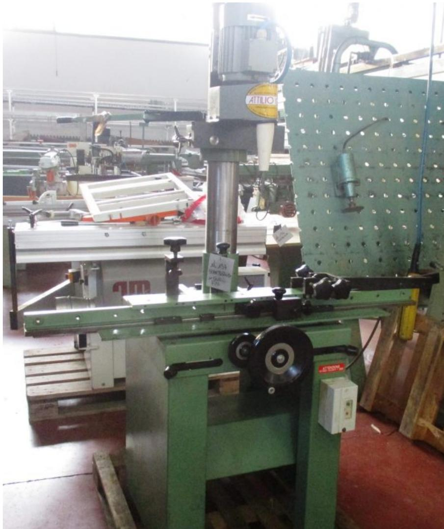
**Descrizione:** CAVETTATRICE PER PERSIANE PER CURVI FIN MOD. CP86//650 - motore trifase hp2 - giri punta 14.000 - dimensioni cm. 1300x950x1820 - peso netto 150 kg. - inclinazione delle cave regolabile 0°- 65° - possibilità di eseguire sestri fino ad un raggio mm.650 - peso delle cave a richiesta n. passi 4 - diametro punta a richiesta mm.9/12
