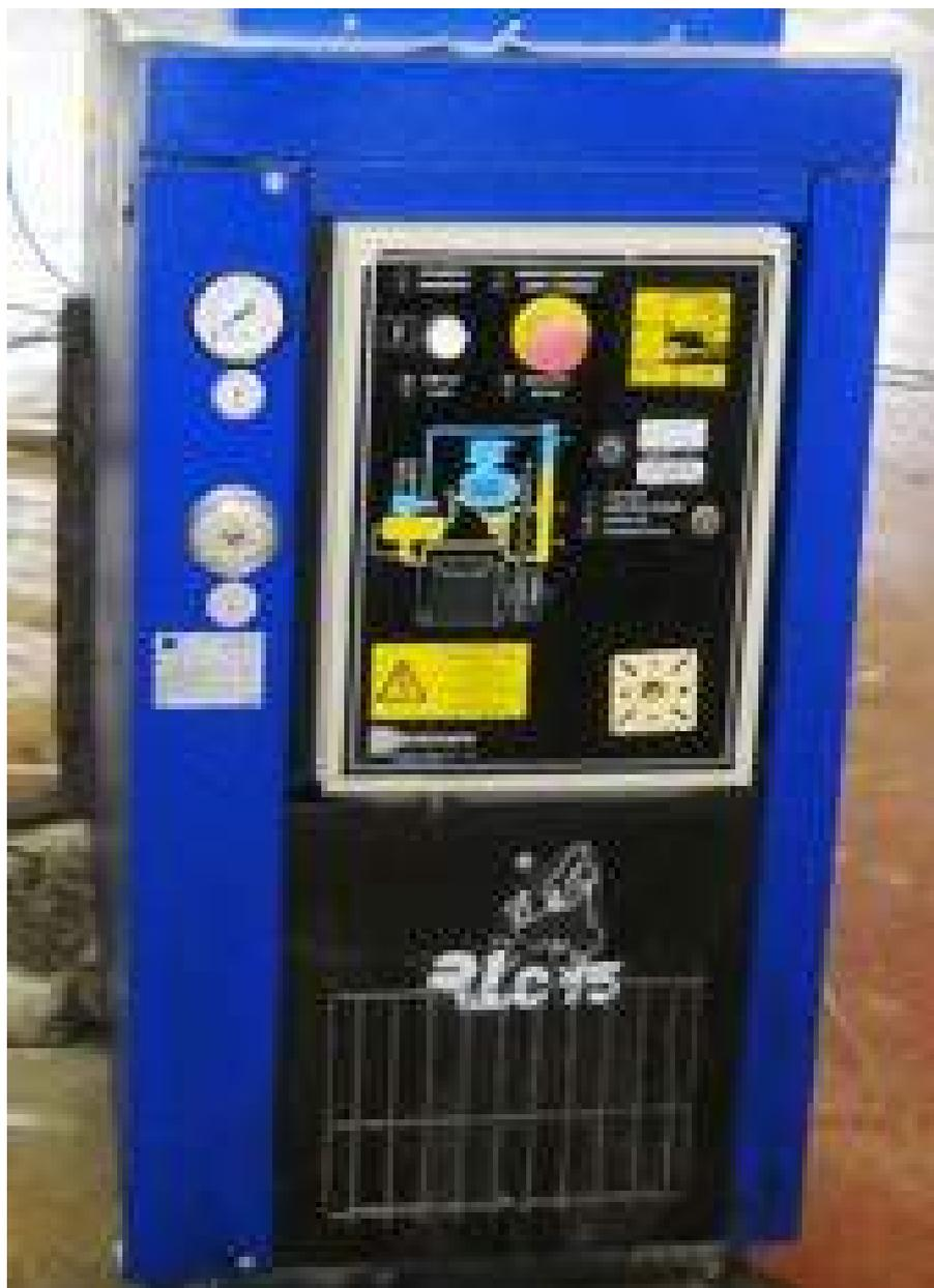
**Descrizione:** COMPRESSORE CECCATO MOD. BLC 15-8 - motore kw 11 cavalli 15 - pressione esercizio 8 bar - a normative CE
