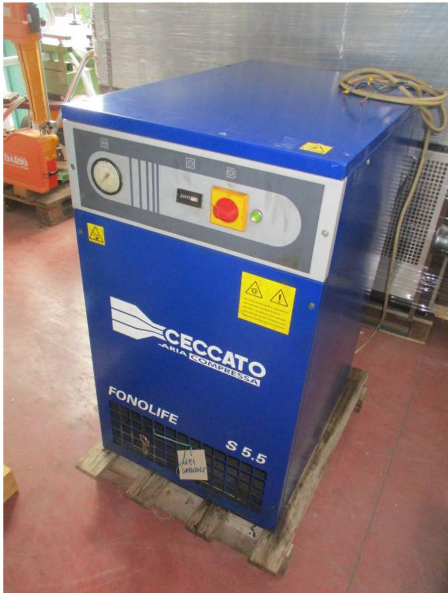
**Descrizione:** COMPRESSORE CECCATO FONOLIFE 5,5 REVISIONATO - a norme CE - motore kw 4
