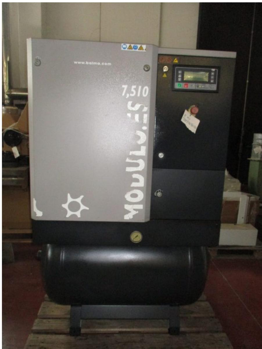
**Descrizione:** Compressore Balma mod. MODULO ES 7,5 - a norme CE - portata aria libera m<sup>3</sup>/min 1,04 - pressione esercizio 10 bar - potenza kw 7,5 - serbatoio lt.270 - completamente revisionato
