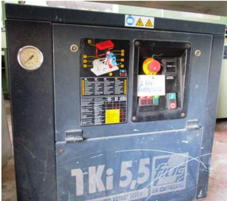
**Descrizione:** COMPRESSORE A VITE FIAC TKI 5,5 a norme CE - aria res al/min. 420
