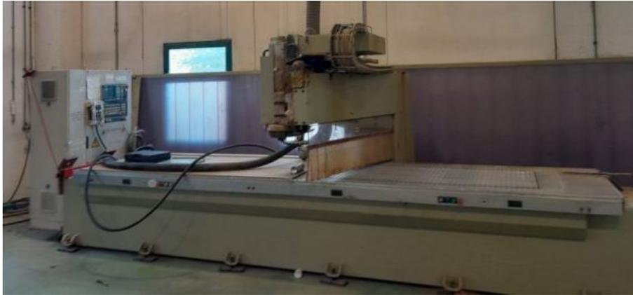
**Descrizione:** CENTRO DI LAVORO SCM MOD. RECORD 220 - a norme CE - n.3 assi - corsa assi X - Y = mm. 3250x1300 - campo di lavoro: \*con gruppo operatore di fresatura mm. 3180x1250 \*con tutti gruppi operatori mm. 2860x1160 - passaggio pezzo mm. 320 - piano multifunzionale mm. 5200x1200 - pompa del vuoto 250 - controllo NUM - cambio utensili RAPID 10
