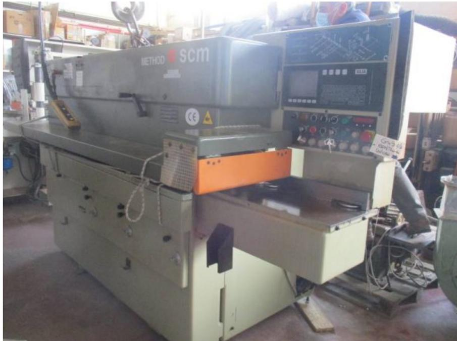
**Descrizione:** CENTRO DI LAVORO SCM MOD. METHOD K - a norme CE - SENZA UTENSILI - spostamento manuale dell'inclinazione guida porta pezzo, visualizzata da controllo, applicazione su guida con battuta manuale - potenza hp15 gruppo pos.2, hp 15 gruppi 3/ (?) - battuta di lunghezza pezzo
