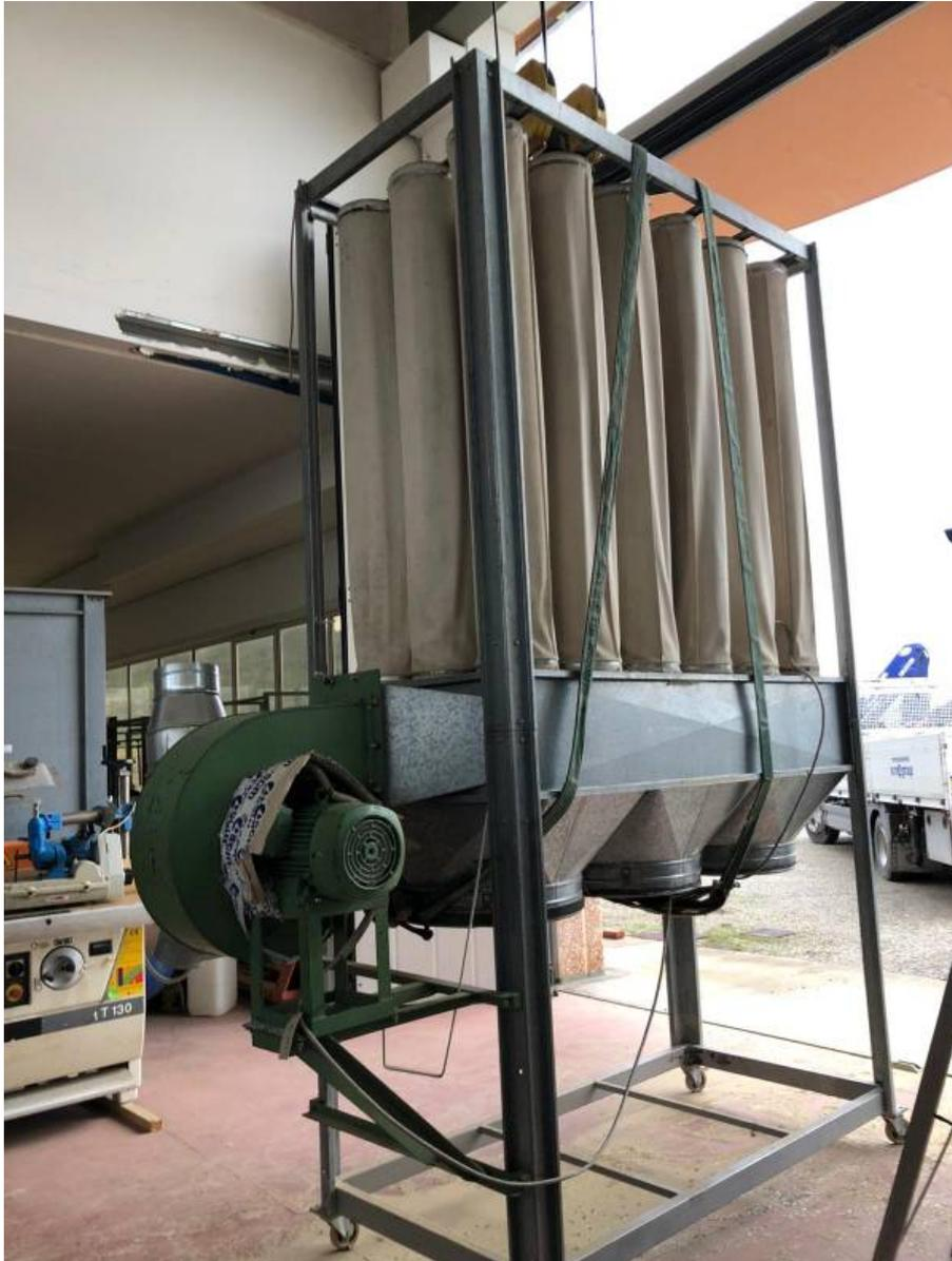
**Descrizione:** CASTELLO FILTRANTE GOA A 3 SACCHI DIAM. 600 - n.18 maniche filtranti altezza mm.1700 diam. 250 mm.
