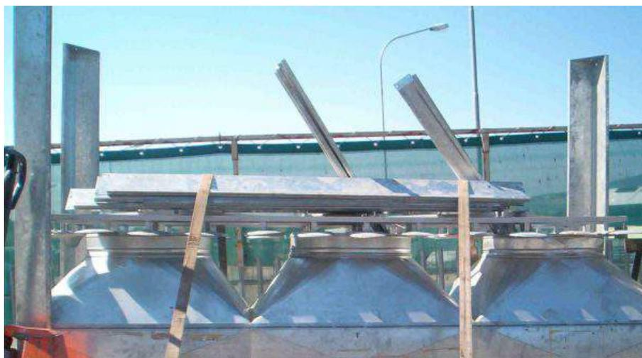
**Descrizione:** CASTELLO FILTRANTE - A 3 SACCHI DI RACCOLTA diam.600 - n.48 maniche diam.200 lungh.1600 - scuotitore aut.co - senza motore
