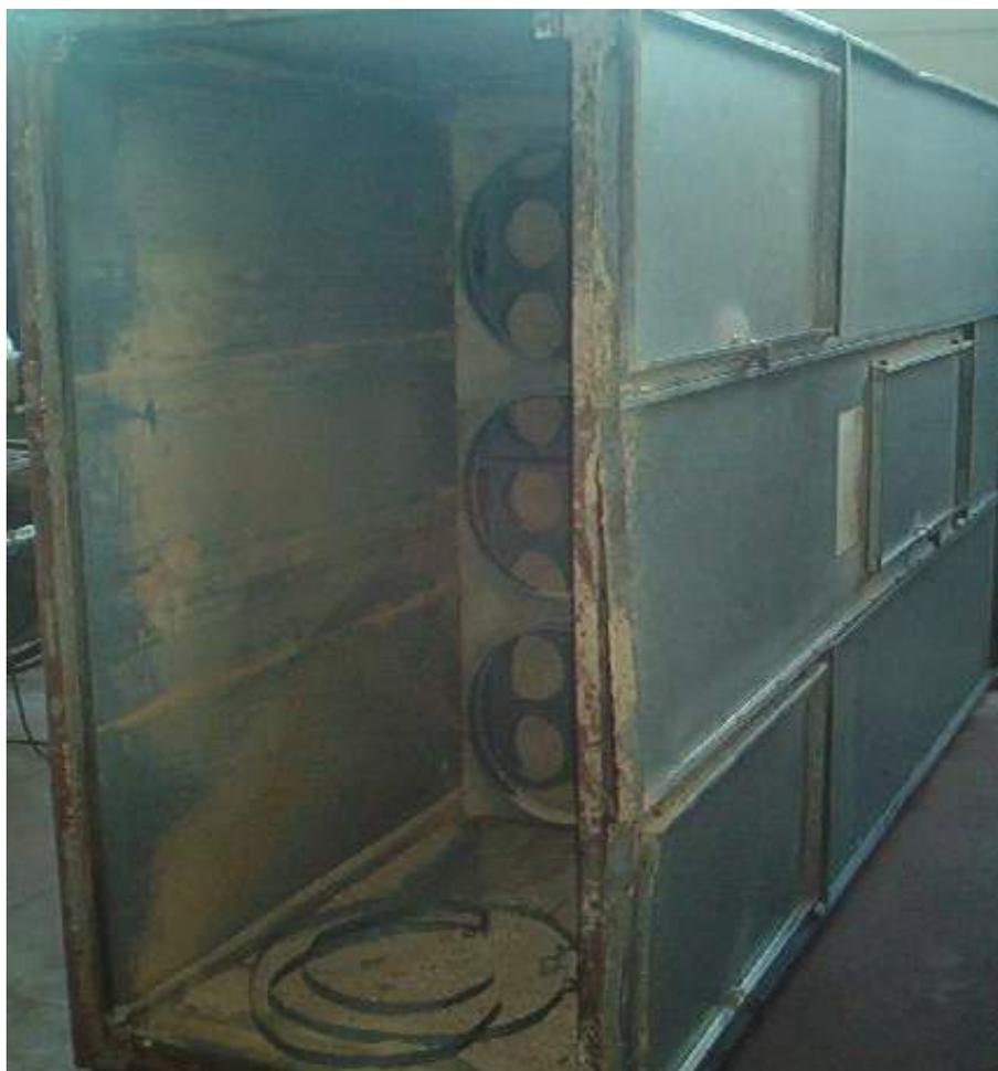
**Descrizione:** CASTELLO FILTRANTE A 27 MANICHE DIAM. 200 LUNGHE MM.2000 - n.3 sacchi di raccolta diam.500 - senza motore
