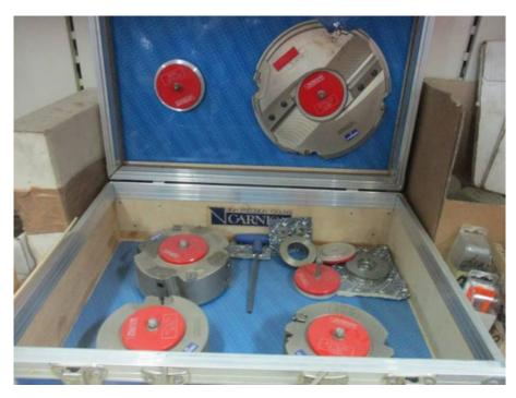
**Descrizione**: CASSETTA FRESE GARNIGA Così composte: - n.2 fresa a spessore variabile multiuso diam. 140x50x35 - n.3 fresa per piattabanda tipo 4x4 diam. 220 - n.3 frese per profili sagomati con inserti intercambiabili in HSS
