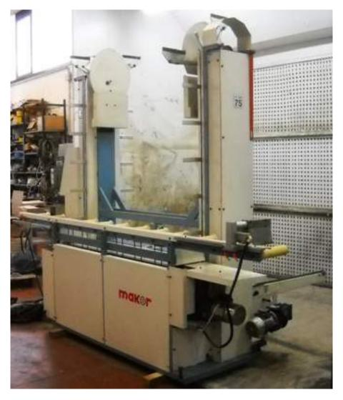
**Descrizione**: CARICATORE PER CARRELLI MAKOR MOD. ACA/2 - interasse tra catena e catena mm. 1500 Fine linea - a norme CE - con n. 4 carrelli per essiccazione \*interasse di ciascun carrello 160 \*n.12 bracci da nmt.1 cad. per ogni carrelli Fine linea
