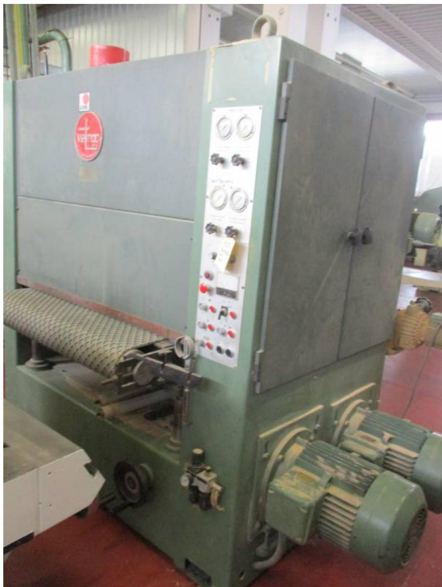
**Descrizione:** CALIBRATRICE VIET da 1000 - a 2 gruppi: \*primo gruppo in gomma 85 sh diam. 300 motore hp 15 \*secondo gruppo tampone motore 2 vel. hp 12/15 - hp.2 - satinatore in uscita - soffiatori primo gruppo e secondo gruppo - tappeto avanzamento con motovariatore
