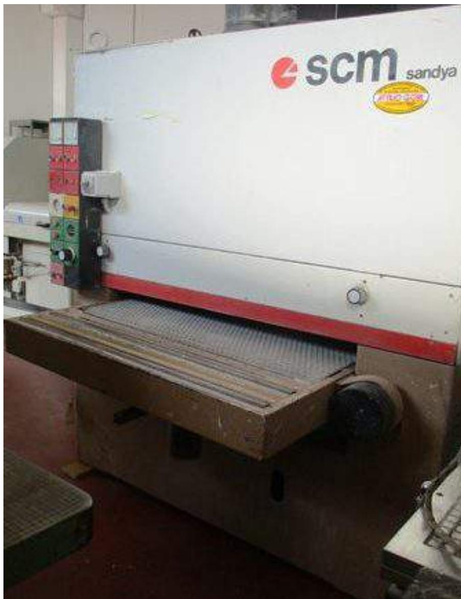
**Descrizione:** CALIBRATRICE SCM MOD. CL2R/110 - variat. vel. tappeto - 1° rullo 65 Sh - motore hp 12,5-15 - 2° rullo 35 Sh - motore hp 10 - soffiatori 1° e 2° nastro - diam. rulli mm. 320 - piano flottante - tappeto forato senza depressione - n.4 bocchette aspirazione diam. 150 - sv. nastri 2150x1115 mm.
