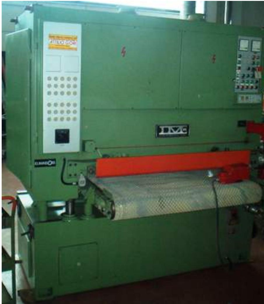
**Descrizione:** CALIBRATRICE DMC DA 1300 - SVILUPPO NASTRI 2620X1350 ad un nastro - RULLO/SCOTCHBRYTE/spazzola - variatore di velocità primo rullo con variatore - rullo 30sh (verificare se v'è rivulcanizzato) - tappeto SEMINUOVO - soffiatori - tampone sul piano o tappeto - velocità variabile sul tappeto - macchina da linea: piano fisso gruppi che scendono dal sopra - misuratore del pezzo
