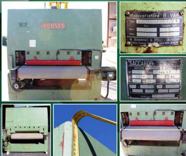
**Descrizione:** Calibratrice a contatto Costa - singolo rullo ad aria compressa - motore asincrono 3 fasi hp 30 - rulliera mm.2500x1450 h. regolabile
