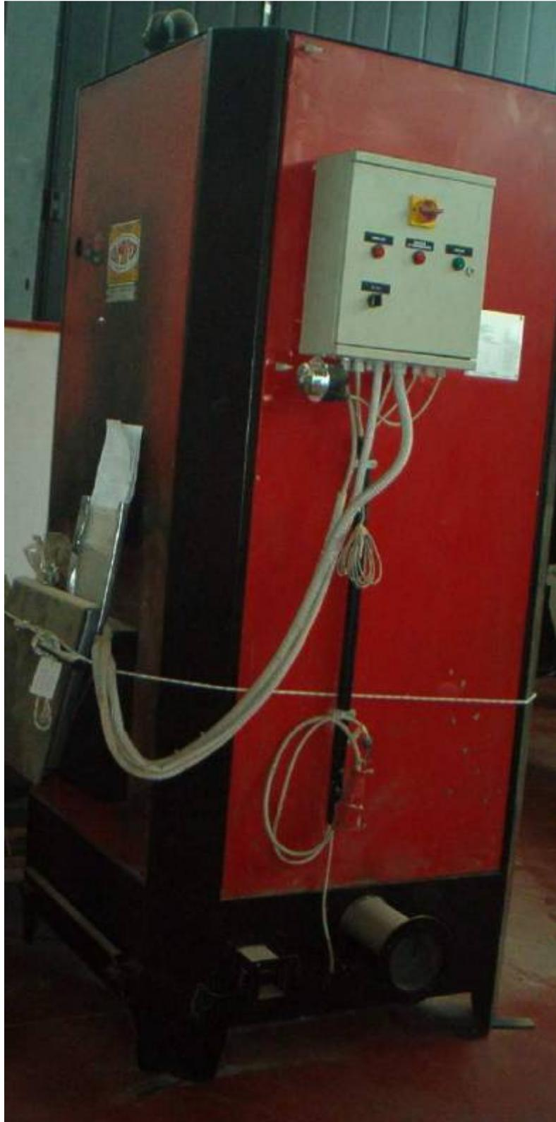
**Descrizione:** CALDAIA COMAFER TURBOMATIC MOD. T150 - pressione d'esercizio 2 kg./cm<sup>2</sup> - temperatura 90° c - capacità lt.400 - potenza focolare 200.000 k/cal/h - potenza al nominale 150.000 k/cal/h + alimentatore con coclea: \*altezza utile mm. 900 \*diam. interno mm.1000 \*lunghezza coclea mm. 600 \*diam. coclea mm. 120 + contenitore con alimentazioen a coclea
