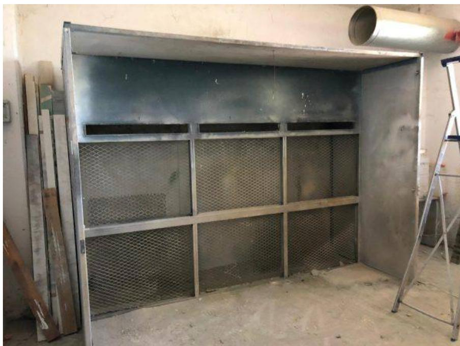
**Descrizione:** Cabina di verniciatura da mt.3 kw 2,2
