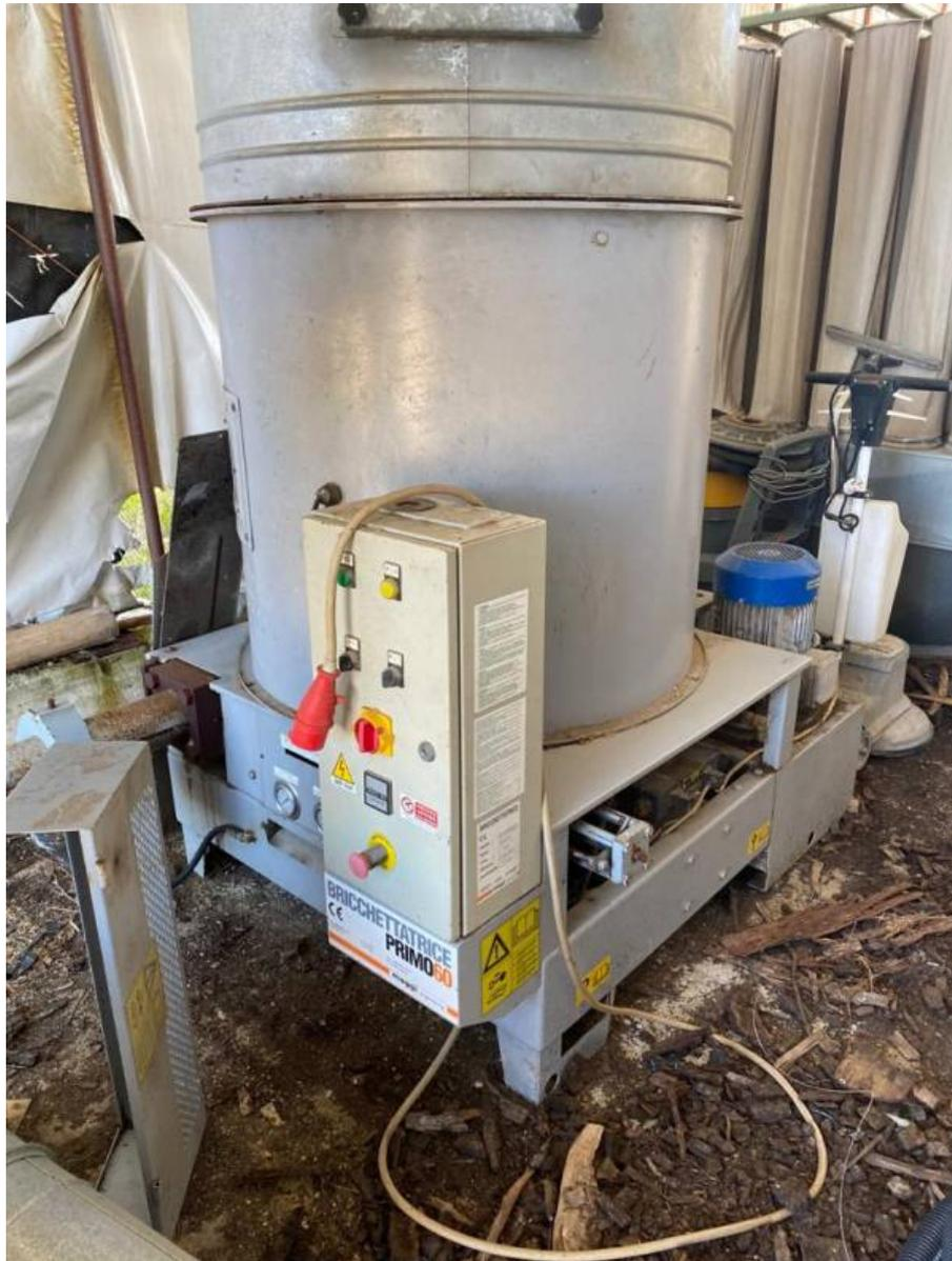
**Descrizione:** BRICCHETTATRICE PRODECO MOD. M 60 - bricchetto diam. 60 - virola diam. mm. 1000 con sportello d'ispezione - motore kw 55,5 h 7,5 - prolunga x virola h. mm. 800 con sportello d'ispezione
