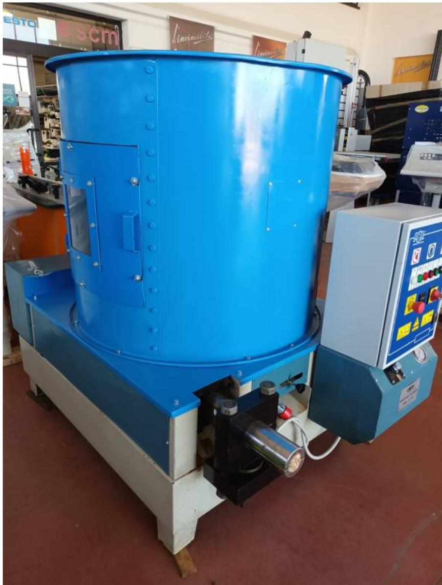
**Descrizione:** BRICCHETTATRICE COMAFER MOD. IDRA 50/30 Completamente revisionata: - quadro elettrico unico - pressostato - olio LI/46 - pulizia vasca - indicatore LVOT 76/10 - fincorsa FR 550 - fincorsa FR 5551 X CIL. - filtro olio completo - serie tubi flex junior - sonda di livello - raschiatore - tappo sfiato Pronta consegna
