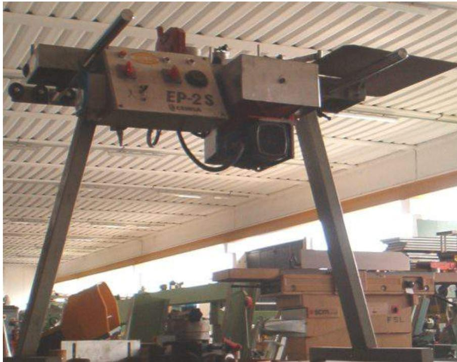
**Descrizione:** BORDATRICE CEHISA MOD. EP-2S - motore KW.0,25 - con TAGLIERINA - a colla termofondente - per bordi singoli o a rotoli in melaminico, laminato, PVC, impiallacciatura - righette. - Distribuzione della colla sul pannello con cilindro motorizzato. - Facilità di regolazione. - Praticità, semplicità d'uso. - Dati tecnici: \*altezza bordo max 50 mm. \*spessore max bordo 3 mm. \*motore trifase 220/380 v.
