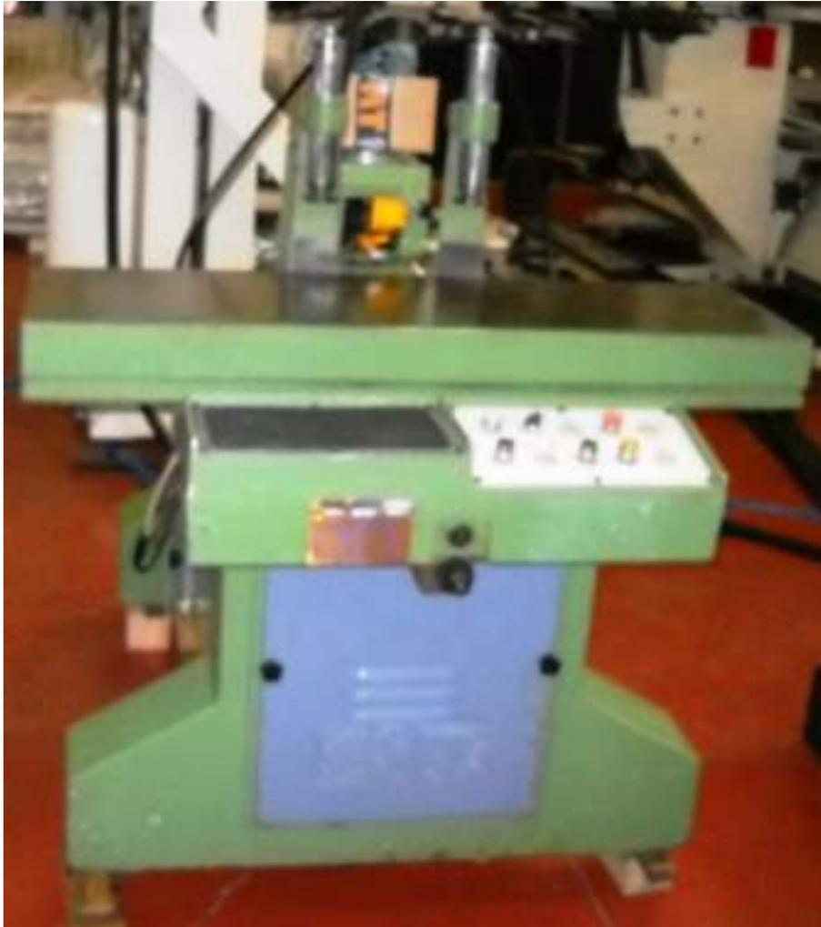
**Descrizione:** BEDANATRICE ORIZZONTALE LARI E BROGI MOD. LB1/M2 - potenza motore kw 3
