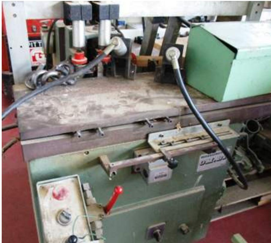
**Descrizione:** BEDANATRICE MUTI MOD. OMB1 - a una testa - doppio pressore verticale e frontale - motore hp3 2 poli - profondità max della cava 130 mm. - regolazione verticale della testa 100 mm. - dimensioni della tavola 1000x300 mm. - altezza del piano di lavoro 820 mm. - pressione di lavoro 6-8 bar - consumo aria per ciclo lt. 15
