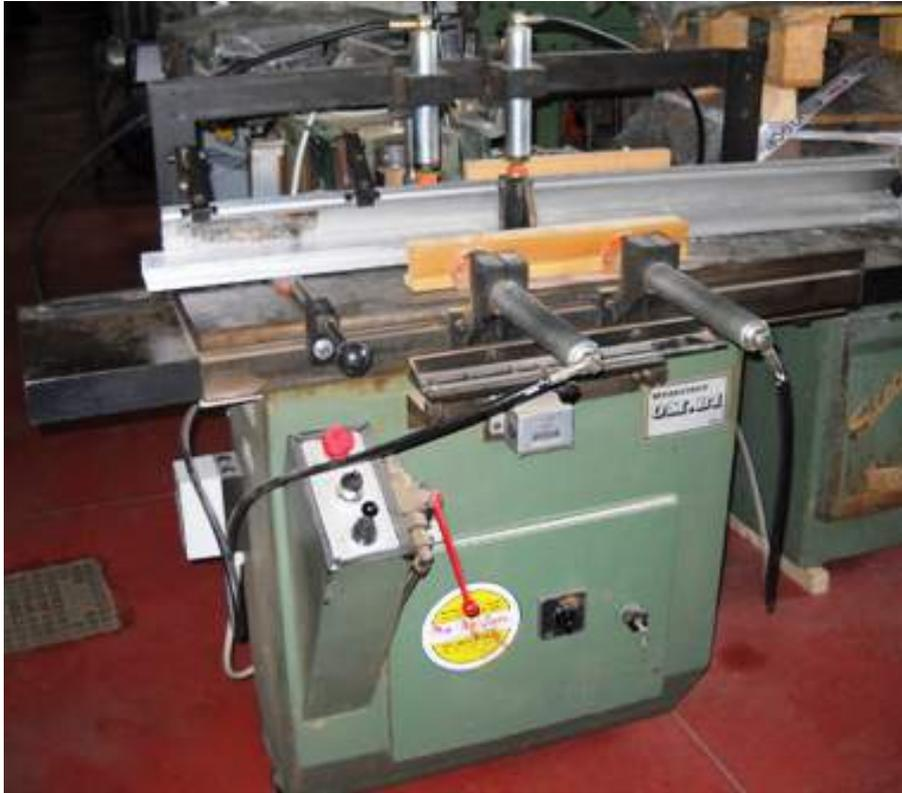
**Descrizione:** BEDANATRICE MUTI MOD. OMB1-ECO - automatica - a una testa - doppio pressore verticale e frontale - motore hp3 2 poli - profondità max della cava 130 mm. - regolazione verticale della testa 100 mm. - dimensioni della tavola 1000x300 mm. - altezza del piano di lavoro 820 mm. - pressione di lavoro 6-8 bar - consumo aria per ciclo lt. 15
