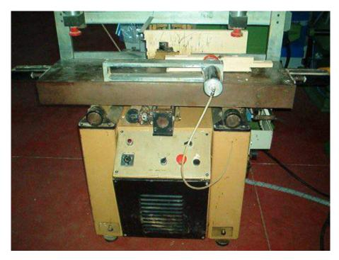
**Descrizione**: BEDANATRICE MUTI MOD. OMB1-ECO - automatica - a una testa - motore hp3 2 poli - profondità max della cava 130 mm. - regolazione verticale della testa 100 mm. - dimensioni della tavola 1000x300 mm. - altezza del piano di lavoro 820 mm. - pressione di lavoro 6-8 bar - consumo aria per ciclo lt. 15
