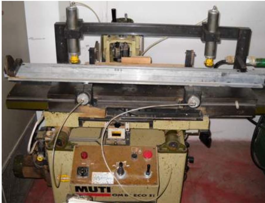
**Descrizione:** BEDANATRICE MUTI MOD. OMB1 ECO SI - dimensione del piano di lavoro mm. 250x1000 - altezza piano di lavoro mm. 860 - corsa longitudinale piano di lavoro mm. 350 - profondità max di lavoro mm. 130 - regolazione verticale della testa mm. 100 - motore testa hp 3 - motore centralina idraulica hp 0,5
