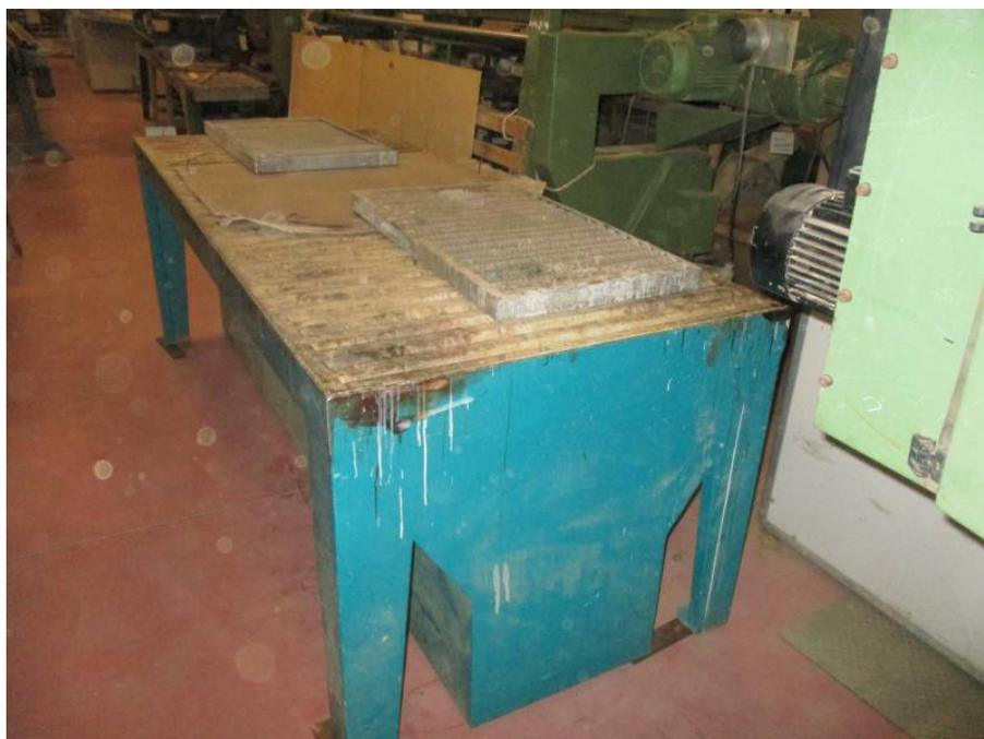
**Descrizione:** BANCO ASPIRANTE mm. 2500x1100 (da collegare a impianto di aspirazione diam. mm. 300)
