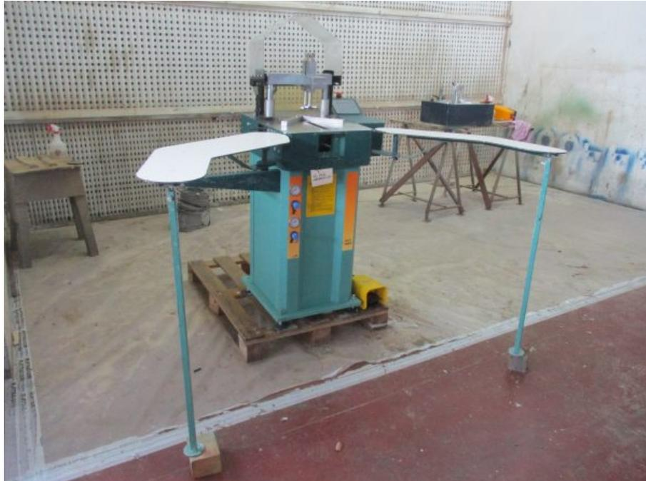
**Descrizione:** Aggraffatrice elettronica Motta Brevetti Mod. AUT 2000 - dimensioni max delle aste lavorabili mm.120 (4 3/4") - produzione oraria possibile circa 250 cornici
